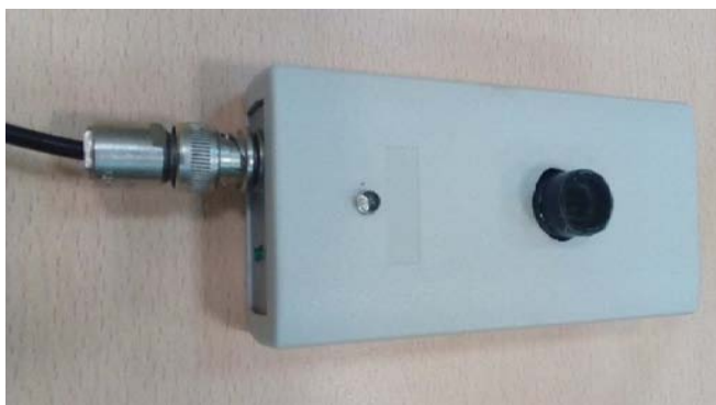
Рис. 3 Прибор для обнаружения скрытых систем оптического видения (внешний вид)
