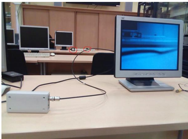
Рис. 10 Сканирование на дистанции 3 м. (красным выделены камеры, которые необходимо обнаружить)
