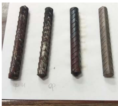
Фото 2.- Арматура после 15-ти суток контакта с шахтной водой
