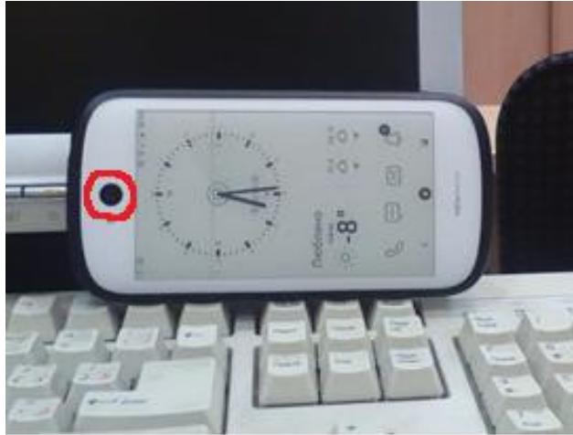
Рис. 5 Фронтальная камера телефона (красным выделена непосредственно камера)
