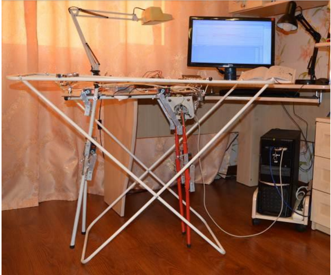
Рис. 5 Квадропедикулярная биоморфная шагающая платформа подвешенная на испытательном стенде.
