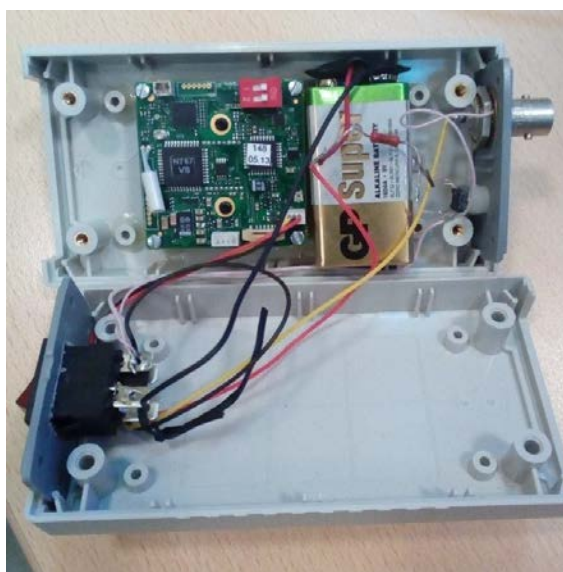
Рис. 4 Прибор для обнаружения скрытых систем оптического видения (внутренние части)
