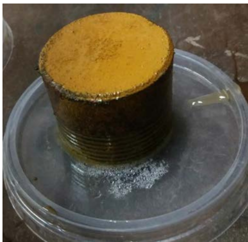
Фото 3. Деталь из Ст45 без фосфатного покрытия после контакта с шахтной водой
