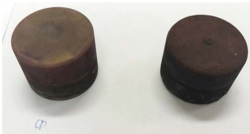
Фото 4. Слой цементной меди на деталях из Ст45 (слева – с фосфатным покрытием, справа – без фосфатного покрытия)
